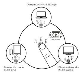
Presiona el selector de equipo para cambiar entre los dispositivos conectados. El indicador con el numero correspondiente encenderá: (1) Dongle / (2 y 3) equipo conectado a bluetoot.
