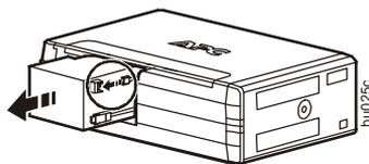
2 Extraiga la batería. Conecte el cable.
